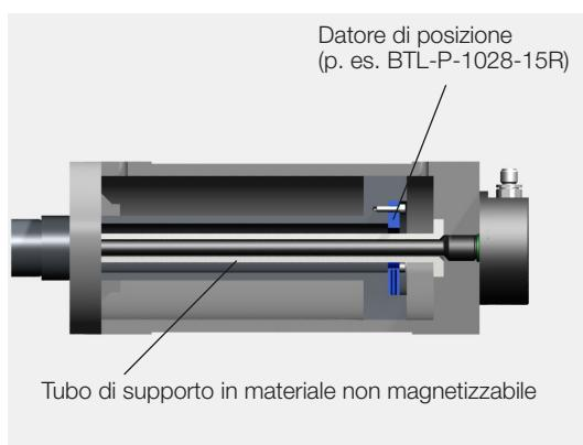
Fig. 4-7: Esempio 2, il trasduttore di posizione viene montato con un tubo di supporto
