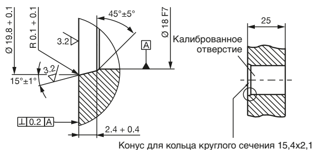
Рис. 4-4: Калиброванное отверстие для монтажа системы BTL с кольцом круглого сечения
