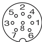
Fig. 4-3 : Affectation des broches du BKS Connecteur du BTL
