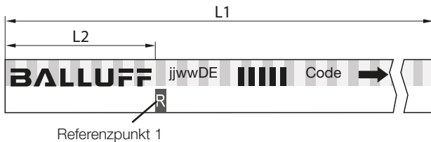
Bild 3-5: Einzel-Referenzpunkt-Magnetband-Maßkörper, Einzel-Referenzpunkt, optisch markiert
