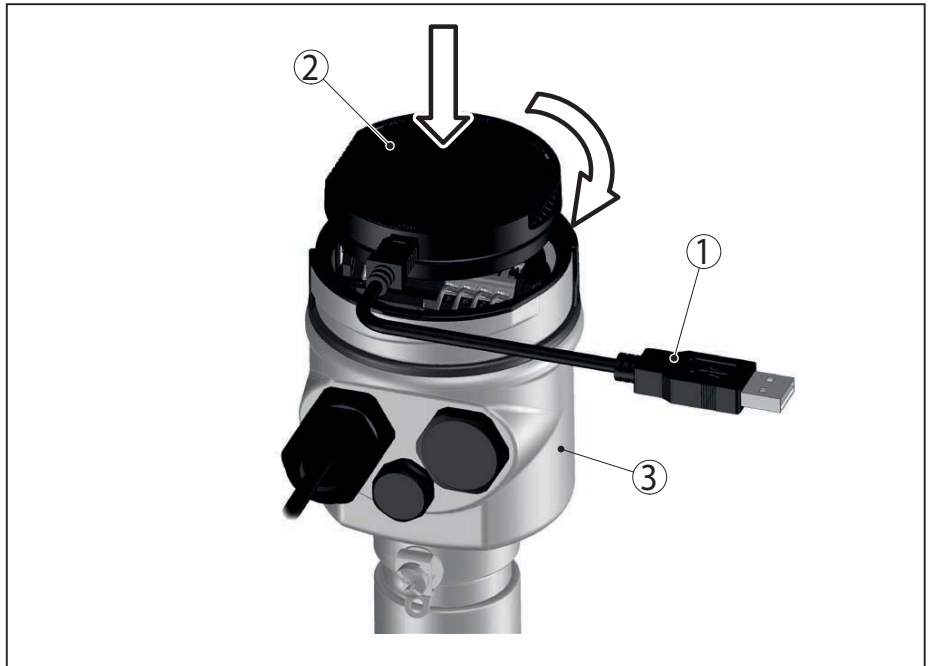
插图. 20: 通过接口适配器将电脑直接与传感器相连
