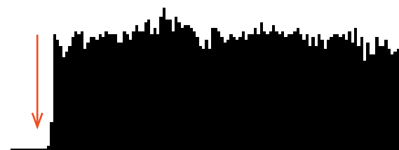
Bild 3-7: Lichtband falsch ausgerichtet, linker Rand der CCD nicht beleuchtet
