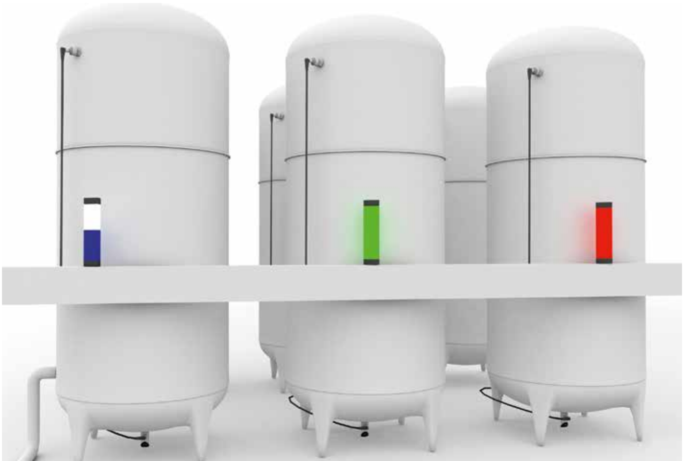
Füllstand der Lagertanks wird kontinuierlich visualisiert.
