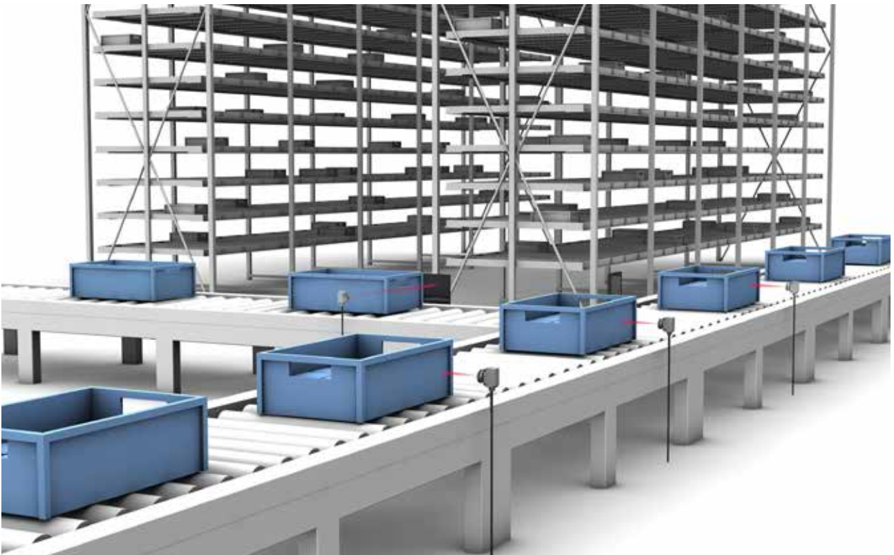
컨베이어 벨트 위의 상자 감지
