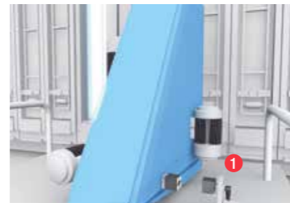
DETECCIÓN DE POSICIÓN EN LA MÁQUINA EXPULSORA Con sensores inductivos BES
