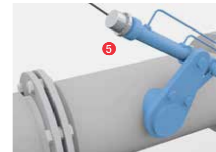
REGULAR CON SEGURIDAD LA ALIMENTACIÓN DE AIRE Y GAS EN EL ALTO HORNO Con sensores magnetostrictivos BTL
