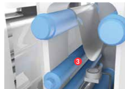
ALIMENTACIÓN DE CHAPA PARA LA BOBINA Con sensores ultrasónicos BUS
