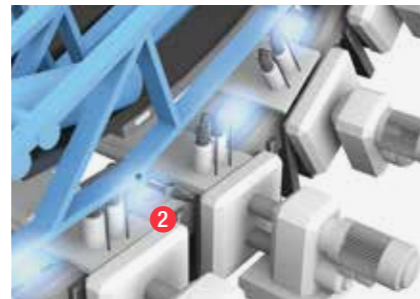
EXPLORACIÓN DE POSICIÓN EN LA COLADA FRÍA Con sensores de campo magnético BMF
