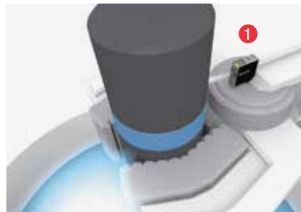
CONTROL DE ELECTRODOS EN EL HORNO DE ARCO ELÉCTRICO Con sensores de contraste BKT
