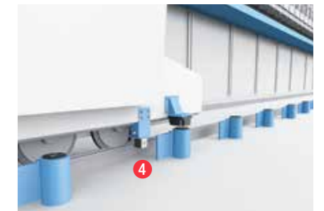
CONTROLAR EL CARRO EXPULSOR Con sistemas industriales RFID BIS
