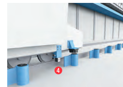
CONTROL THE PUSHER CARS BIS industrial RFID systems
