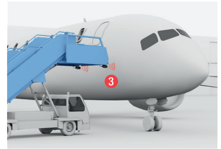
AVIÓN: POSICIONAR LA ESCALERA DE FORMA ÓPTIMA Con sensores ultrasónicos BUS
