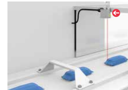
NEIGUNGSABWEICHUNG DES SENSORS ERKENNEN Smart Automation and Monitoring System Sensoren SAMS
